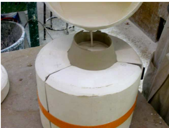
5/ Remplissage de l'espace libre à l'intérieur de la pièce avec du plâtre pour bloquer les radios et rigidifier l'ensemble.
