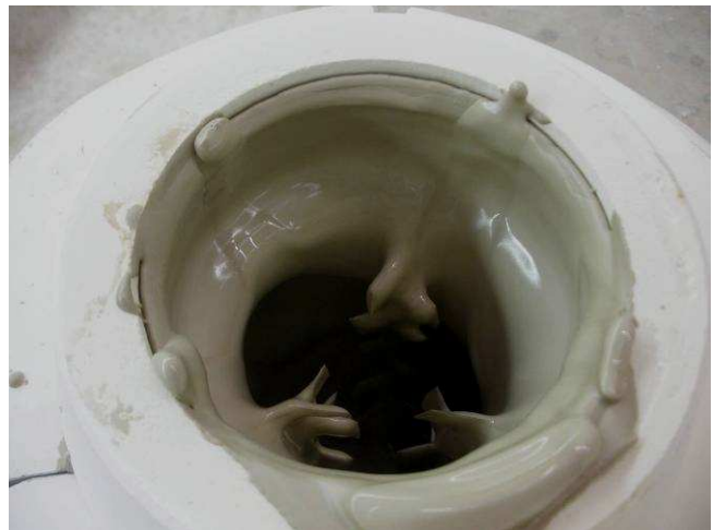
4/ Moule vidé de l'excès de terre (les crans d'ancrage restent ± enrobés de terre). Attendre que la terre ne colle plus sur les doigts.
