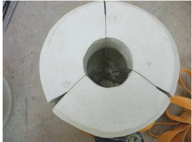
2/ Fermeture du moule laissant voir l'ensemble des prises (crans d'ancrage) réalisées dans les radios.
