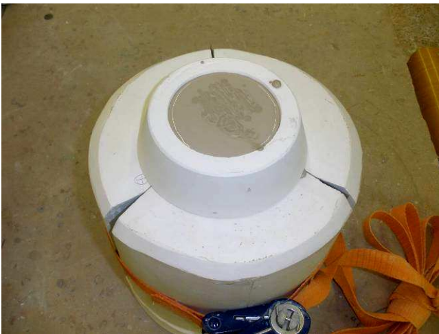
3/ Remplissage du moule avec de la barbotine de coulage (terre liquide). Ajouter une réserve mobile en guise de nourrice.
