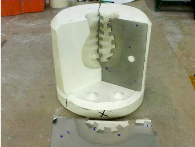
1/ Préparation des radios aux dimensions du moule existant avec crans d'ancrage trous pour les futurs tenons en plastique.
