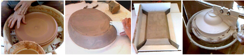
Sur le tour de potier Ovale par traînage 1 coulée = 4 parties En plâtre calibré Maison de la Céramique de Dieulefit : exemples autour de l'estampage.
