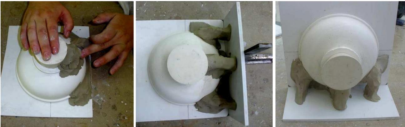
**1/ Centrer le modèle à plat sur une plaque en alignant sa ligne de dépouille sur une horizontale tracée sur la plaque et commencer à caler le modèle à la terre.**
